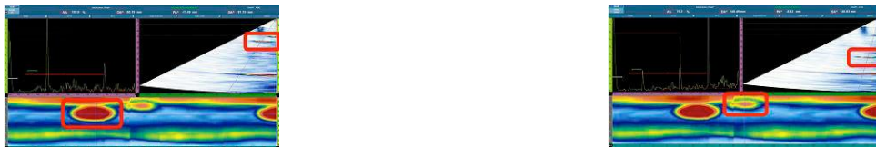
Abbildung 13: Ergebnisse der Fehler, die sich 80 mm (links) und 140 mm (rechts) von der Oberseite des Schraubenkopfs befinden.
